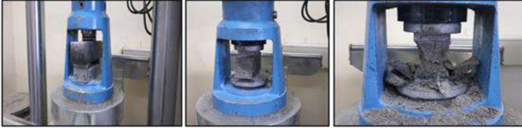
Şekil 3. Prizmatik Numune Örnekleri Üzerinde Yapılan Eğilmede Çekme ve Basınç Dayanımı Deneyleri
