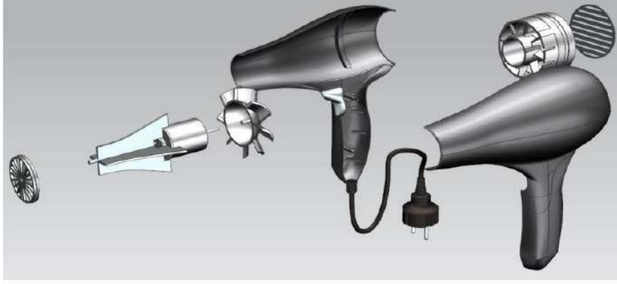
Şekil 7: Sessiz çalışan saç kurutma makinesi motor bütünü , Sessiz çalışan saç kurutma makinesinin 3 boyutlu tasarımı görseli, Sessiz çalışan saç kurutma makinesi patlatılmış katı model görünümü
