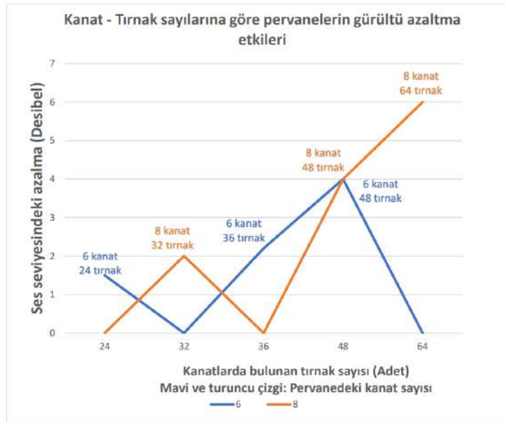
Şekil 4 6 kanat pervane (24, 36 ve 48 tırnak) ve 8 kanat pervane (32,48 ve 64 tırnak) sayılarının gürültü azaltmadaki etkileri
